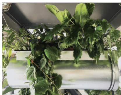
Rys. 2. Fotografia kompletnego filtra biologicznie aktywnego FAB
